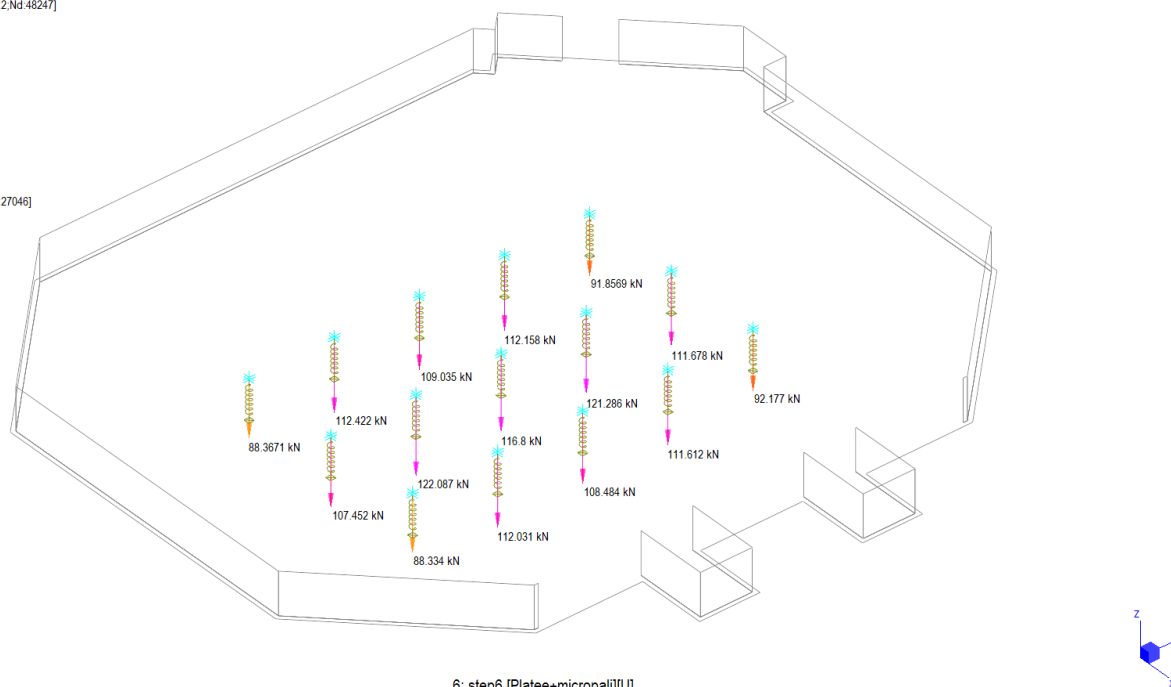
Resistenza a taglio - punzonamento di un solaio senza specifiche armature UNI EN 1992-1-1 § 6.4.4 N_{ed} [kN] 130 sforzo normale massimo della colonna R [kN] 0 reazione del terreno nell'area di controllo D_{el} [mm] 300 diametro minima della sezione punzonante d_x [mm] 263 altezza utile della soletta in direzione x d_z [mm] 249 altezza utile della soletta in direzione z d_{eff} [mm] 256 effettiva altezza utile della soletta u_1 [mm] 4159 u_{1*} [mm] 4159 perimetro di controllo column position: \beta inner column v_{Ed} [MPa] 0.140 eq. 6.49 f_{tk} [MPa] 25 \gamma_c 1.5 \alpha_{cc} 0.85 diameter 1 [mm] span 1 [cm] diameter 2 [mm] span 2 [cm] Area 1 cm 2 /m Area 2 cm 2 /m armatura tesa minima in direzione x [cm 2 /m] 14 20 - 20 7.7 0 armatura tesa minima in direzione z [cm 2 /m] 14 20 - 20 7.7 0 \rho_{1x} 0.003007813 rapporto di armatura tesa in direzione x \rho_{1z} 0.003007813 rapporto di armatura tesa in direzione z \rho_1 0.003007813 k 1.88 v_{Rd,c,1} [MPa] 0.44 eq. 6.50 v_{Rd,c,2} [MPa] 0.45 eq. 6.50 v_{Rd,c} [MPa] 0.45 eq. 6.50 Armatura a aggiuntiva a taglio-punzonamento non richiesta qualora v_{Ed} \leq v_{Rd,c} v_{Ed}/v_{Rd,c} 0.310 Non occorre ulteriore armatura a taglio-punzonamento
