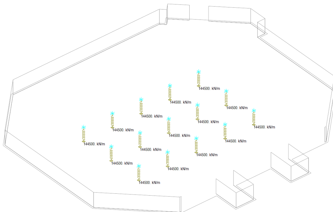
Figura 10-3: Rigidezza assiale delle molle elastiche rappresentative dei micropali di fondazione
