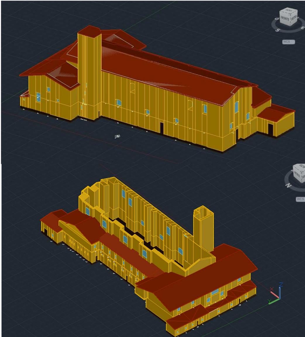
**Figura 4 – restituzione grafica software modellazione energetica.**
