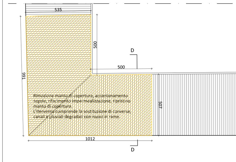
Rimozione manto di copertura, accantonamento tegole, rifacimento impermeabilizzazione, ripristino manto di copertura. L'intervento comprende la sostituzione di converse, canali e pluviali degradati con nuovi in rame.
