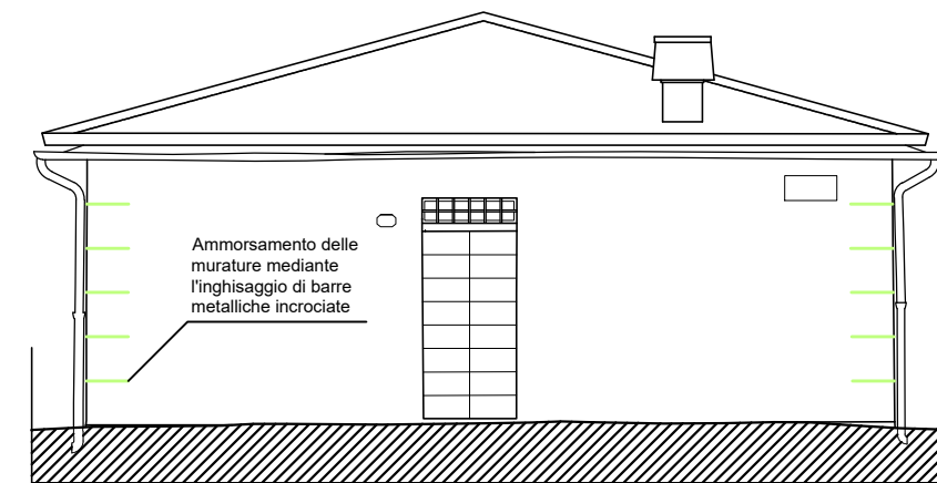
INTERVENTO STRUTTURALE_PROSPETTO SUD_SCALA 1:100
