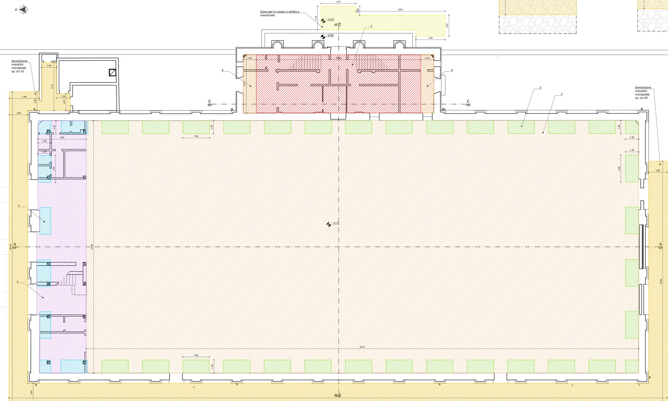
N.B. LE DEMOLIZIONI RAPPRESENTATE NELLA TAVOLA SONO COMPENSATE CON I PREZZI A CORPO WA.03 E WA.04. LE RIMOZIONI DEI SERRAMENTI SONO COMPENSATE CON I PREZZI A CORPO WA.01 E WA.02. LE RIMOZIONI DEGLI IMPIANTI SONO COMPENSATE CON I PREZZI WE.01 E WM.01. LE DEMOLIZIONI DEL MARCIAPIEDE E DELLA ZONA INGRESSO ASFALTATA SONO COMPENSATE A MISURA.
