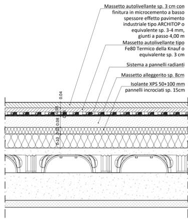
Dettaglio solaio P0 palestra - Nuovo pavimento con massetto cementizio con finitura al quarzo elicoterato - Scala 1:10
