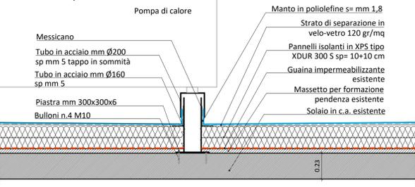
**Particolare piastra di appoggio pompa di calore in copertura - Scala 1:20**
