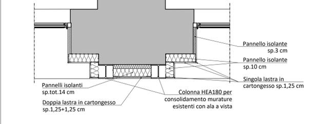
**Particolare Sezione 2-2 Sezione orizzontale sotto finestra - Scala 1:20**
