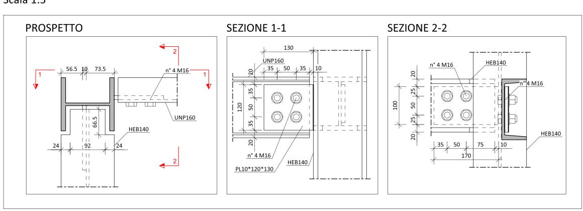
DETTAGLIO V - COLLEGAMENTO COPERTURA CORPO ASCENSORE - PICCHETTI B - D Scala 1:5
